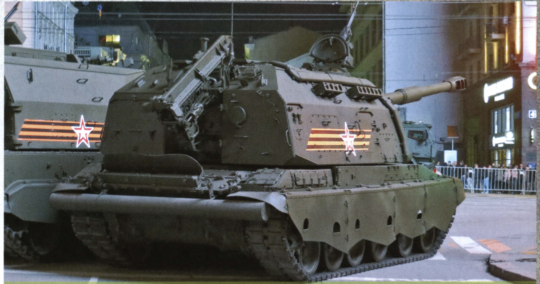
Самоходная установка 2С19М2, вид сзади, май 2015 года. Хорошо виден подающий механизированный лоток для загрузки боекомплекта с грунта.
